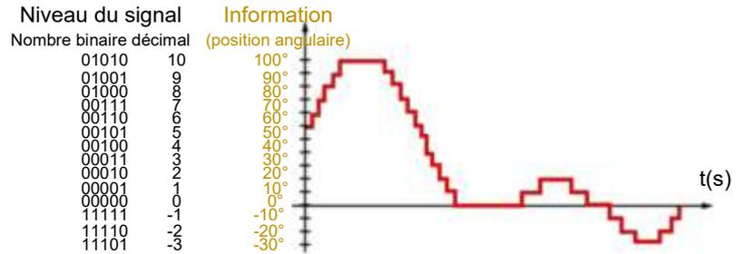
**NOTA** : dans certains cas, il sera nécessaire de convertir un signal analogique en signal numérique : *c'est la conversion analogique/numérique* appelée **CAN** ou alors convertir un *signal numérique en signal analogique*. On parle alors de **CNA**.
