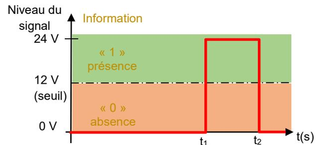
Exemple d'allure d'un signal TOR : CRA issu d'un capteur de présence.
